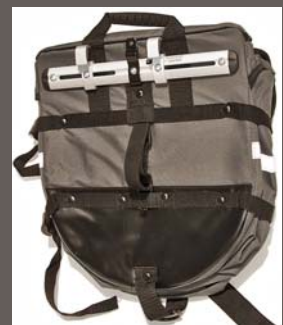
U modulových systémů brašen je využíván speciální durulový úchyt s háčky a pojistkou. Díky tomu jsou montáž i sundání brašen velmi jednoduché. Háčky jsou posuvné se zajištěním na imbus, pojistka jen jednoduše propuší a nosič zapadne do jejího zahnutí.
