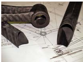
Přesně nařezané trubky z kompozitních materiálů IM 600 a M 40 (viz článek o návštěvě v továrně Bianchi) se začístí podobně jako tomu je u duralových trubek
