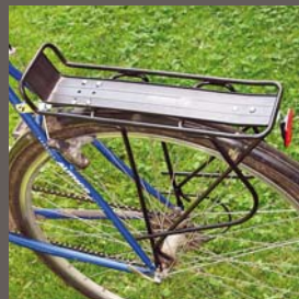
Nosič pro namontování napravo k rámu by měl mít dostatečně odolnou konstrukci. Prohnuté boční výtuhy nejen zpevňují konstrukci, ale také poskytnou lepší oporu bočními stěnami brašen.
