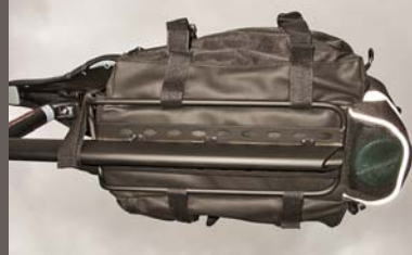
Uchycení většiny brašen k nosiči je řešeno stahovacími páskami na suchý zip. Upevnění a demontáž jsou tedy trochu pracnější. Moderní řešení využívají plastovou desku s „click“ systémem, kde všechno jistě jediná pojistka.
