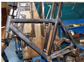
Přesně nařezané trubky z kompozitních materiálů IM 600 a M 40 (viz článek o návštěvě v továrně Bianchi) se začístí podobně jako tomu je u duralových trubek
