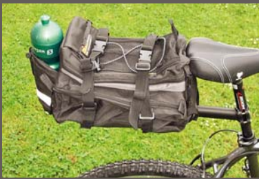
Brašna na sedlovkový nosič má obsah kolem sedmi litrů, nosnost je dána hlavně pevností sedlovky. Omezení jízdyce při posunutí těžší vzad záleží hlavně na výšce a vysunutí brašny vůči sedlovce.
