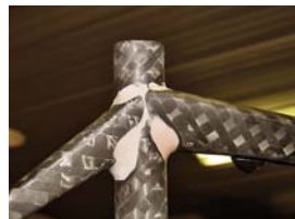
Slepené spoje se začístí a nanese se na ně krycí vrstva, jejíž povrch se dokonale vyhladí, aby k němu dobře přilnula zpevňující karbonová pletenina
