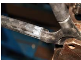
Rám se sesadí do přípravku, který slouží i k vaření duralových a titanových rámu. Vše se slícuje a pospojuje tak, aby se jednotlivé spoje daly slepit
