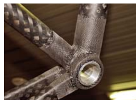
Slepené spoje se omotají karbonovou pleteninou, která tato nejkritičtější místa pojistí proti rozpojení a zároveň dodá i vyšší tuhost. Přesný postup procesu tepelného zpracování, složení pojících materiálů či počet vrstev jsme se však nedozvěděli, toto své knowhow si Bianchi chtělo logicky uchovat.
