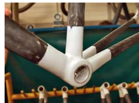
Slepené spoje se začístí a nanese se na ně krycí vrstva, jejíž povrch se dokonale vyhladí, aby k němu dobře přilnula zpevňující karbonová pletenina
