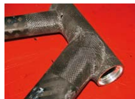
Slepené spoje se omotají karbonovou pleteninou, která tato nejkritičtější místa pojistí proti rozpojení a zároveň dodá i vyšší tuhost. Přesný postup procesu tepelného zpracování, složení pojících materiálů či počet vrstev jsme se však nedozvěděli, toto své knowhow si Bianchi chtělo logicky uchovat.
