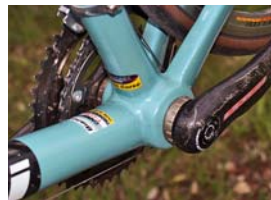
U hotového produktu se po začístění spoju a nastříkání rámu pouhým okem prakticky nedají poznat přechody mezi trubkami a opletením
